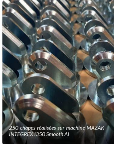
250 chapes réalisées sur machine MAZAK INTEGREX I350 Smooth AI
