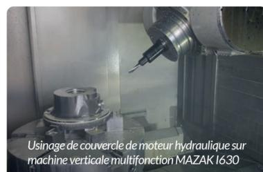
Usinage de couvercle de moteur hydraulique sur machine verticale multifonction MAZAK I630
